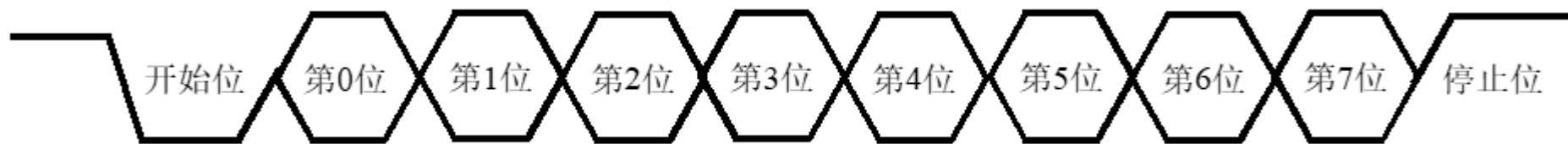
图6-1 串行通信数据格式
